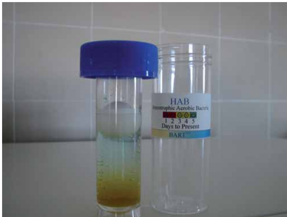
Una provetta per le analisi condotte con il Sistema BART- Biological Activity Reaction Test inventato dal Biologo Roy Cullimore (Droicon Bio concepts Inc., Regina, Canada).
